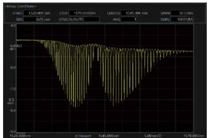
氨化氢 \text{H}_3\text{C}_14\text{N} 的吸收光谱测量(AQ6375E)
