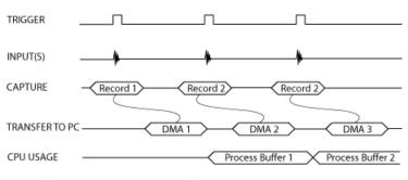
TRIGGERED DATA ACQUISITION USING DUAL-PORT MEMORY
