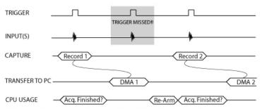
TRIGGERED DATA ACQUISITION USING SINGLE-PORT MEMORY
